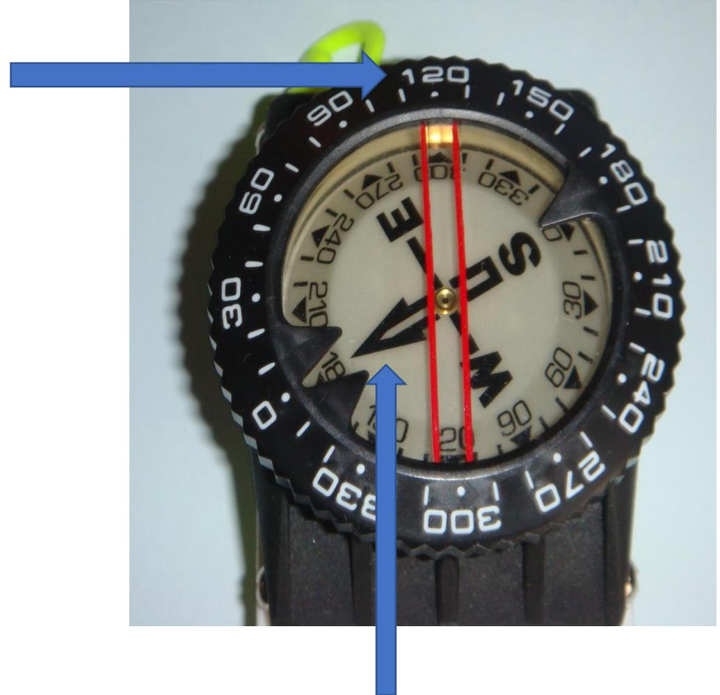
Positionner le **NORD** dans la fenêtre de l'index
