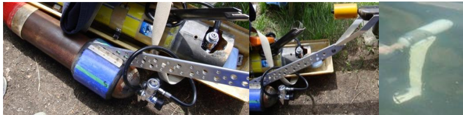
Figure 4 : Système type « Sonnekalb » : Un cerclage est fixé autour de la bouteille d'immersion en acier. La quille qui porte le compas est fixée sur ce cerclage. Le nageur tient la bouteille au niveau de la robinetterie, comme en IS.
