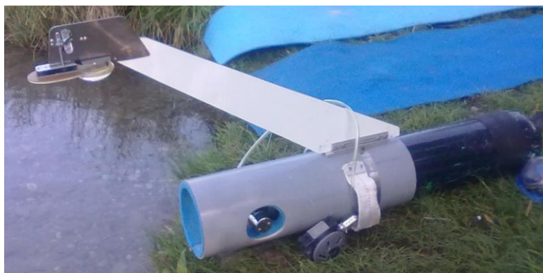
Figure 6 : La bouteille est glissée dans un tube, Les bras entrent dans les sangles situées à l'extérieur du carénage. La tête du nageur se place au bout du tube de PVC (Sur la photo, la bouteille est à l'envers, le compas, dans l'eau se situe sous le nageur).
