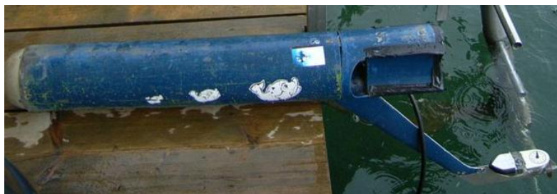
Figure 5 : La bouteille est glissée dans un tube, Les bras entrent dans le carénage au niveau de guides situés dans le prolongement du tube. La tenue de la bouteille se fait au niveau de la robinetterie, comme en IS.
